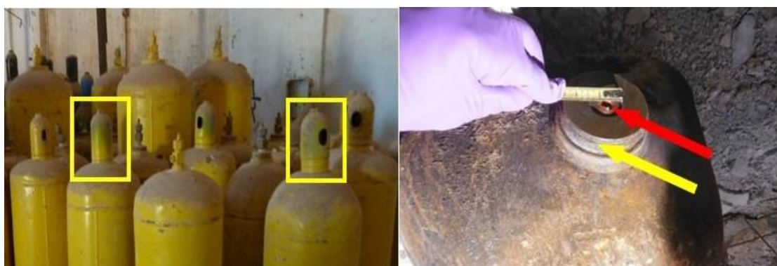
图片 10： 放大的图像（来源：事实调查组）：在 2 号地点发现的工业气瓶，阀门井可见。断裂的阀体（部分仍拧在气瓶口中），标有红色箭头，而用于连接阀护帽的螺纹标有黄色箭头。在先前记录的将氯用作化学武器的事件中使用的气瓶上可以看到类似的阀门损坏（标有红色箭头），例如在卡夫尔泽伊塔，2016 年 10 月 1 日 147 （见蓝色方块内的照片）和萨拉奎布，2018 年 2 月 4 日（见红色方块内的照片） 148 。
