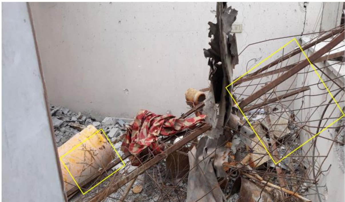
图片 12： 气瓶瓶体上可见的方格模式损坏，形似于屋顶金属网的网格状 (来源：事实调查组)
