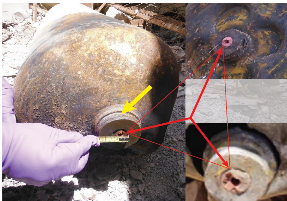
图片 10： 放大的图像（来源：事实调查组）：在 2 号地点发现的工业气瓶，阀门井可见。断裂的阀体（部分仍拧在气瓶口中），标有红色箭头，而用于连接阀护帽的螺纹标有黄色箭头。在先前记录的将氯用作化学武器的事件中使用的气瓶上可以看到类似的阀门损坏（标有红色箭头），例如在卡夫尔泽伊塔，2016 年 10 月 1 日 147 （见蓝色方块内的照片）和萨拉奎布，2018 年 2 月 4 日（见红色方块内的照片） 148 。
