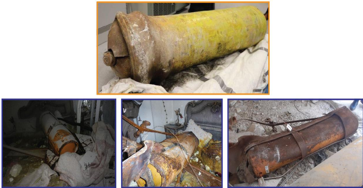
图片 24：其使用化学武器（尤其是氯气）事件中使用的类似气瓶的腐蚀模式（来源：禁化武组织，事实调查组）
