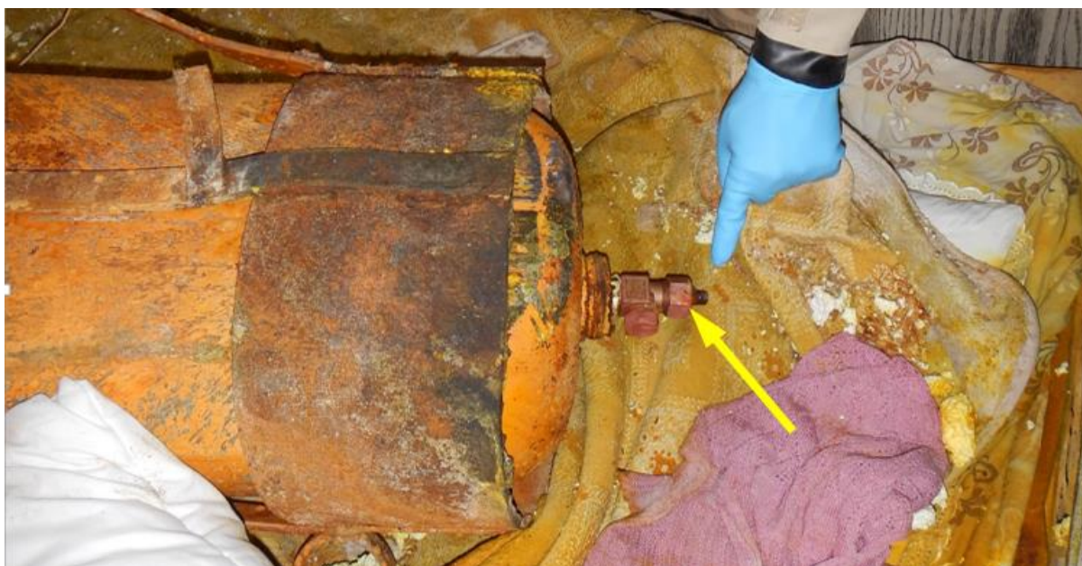
图片 21：发现气瓶时，阀门（黄色箭头标示）还在。（来源：事实调查组）
