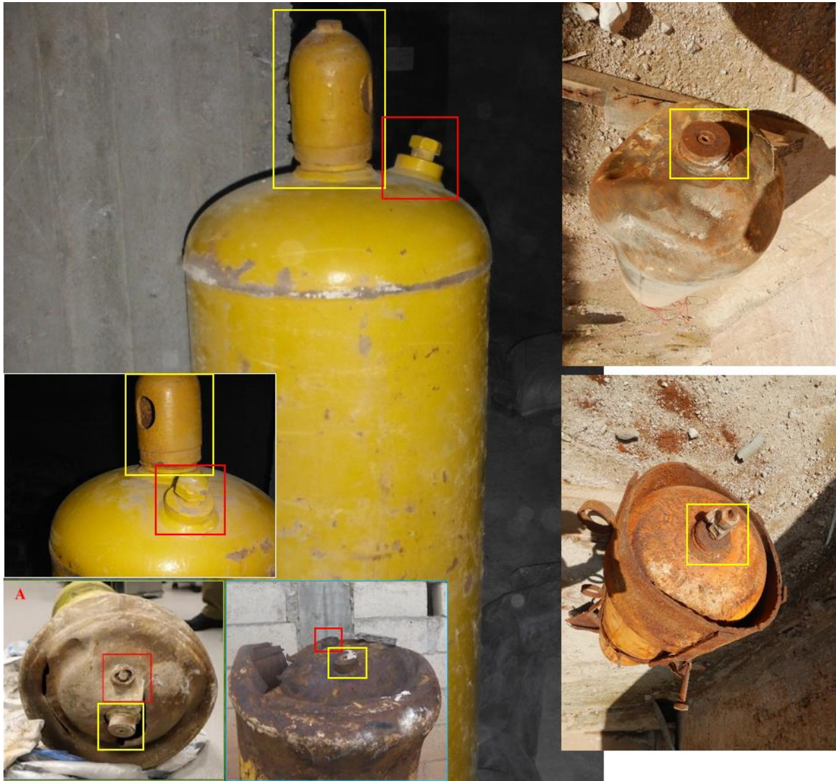
图片 27: 较大的图像: 在仓库地点发现的黄色工业气瓶。气瓶上没有附着的托架并装有阀门护帽 (黄色方块标示)。较小的图像是同一气瓶的顶部示图 (白色标示)。底部图像: 与卡夫尔泽伊塔 (2016 年 10 月 1 日) (绿色标示) 和拉塔梅纳 (2017 年 3 月 25 日) (蓝色标示) 事件中使用的具有相同特征的瓶子。
