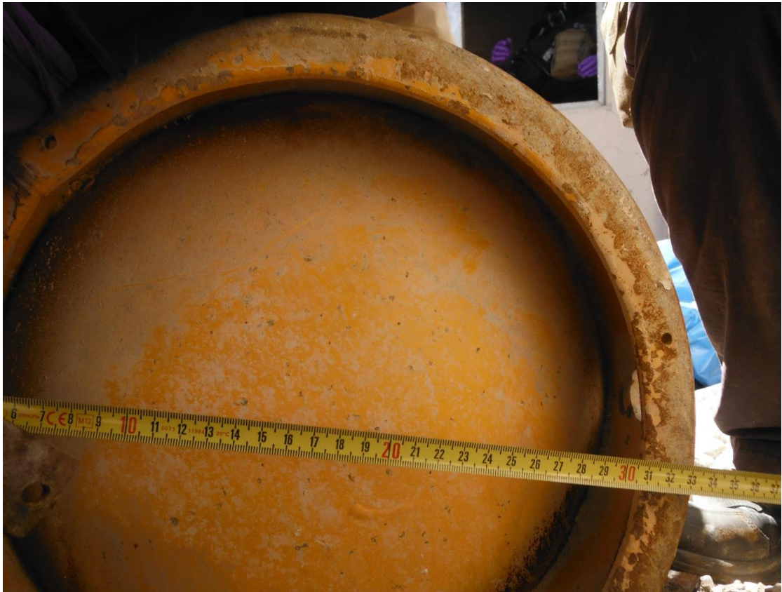
图片 8： 据事实调查组于 2018 年 4 月 21 日测定的在 2 号地点所发现气瓶的底座直径。该气瓶的尺寸与 2018 年 2 月 4 日萨拉奎布化学袭命中使用的气瓶尺寸一致（来源：事实调查组）
