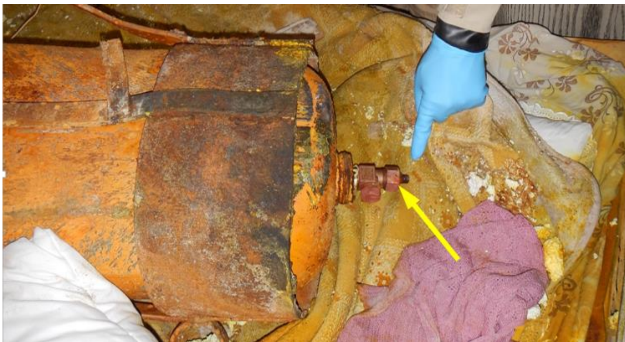
РИСУНОК 21. КЛАПАН (ОТМЕЧЕН ЖЕЛТОЙ СТРЕЛКОЙ) ВСЕ ЕЩЕ ПРИСУТСТВОВАЛ НА МОМЕНТ ОБНАРУЖЕНИЯ БАЛЛОНА (ИСТОЧНИК: МУФ)
