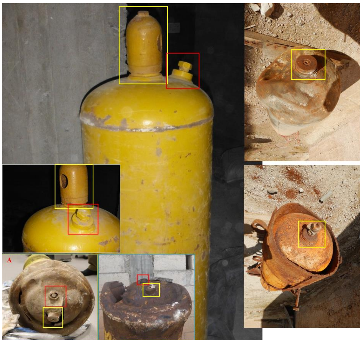
РИСУНОК 27. НА УВЕЛИЧЕННОМ ИЗОБРАЖЕНИИ: ЖЕЛТЫЙ ПРОМЫШЛЕННЫЙ БАЛЛОН, ОБНАРУЖЕННЫЙ НА СКЛАДЕ. К БАЛЛОНУ НЕ ПРИКРЕПЛЕНА ЛЮЛЬКА, НО НА НЕМ УСТАНОВЛЕН ЗАЩИТНЫЙ КОЛПАЧОК КЛАПАНА (ОТМЕЧЕН ЖЕЛТЫМ КВАДРАТОМ). ВЕРХНЯЯ ЧАСТЬ ТОГО ЖЕ БАЛЛОНА ПОКАЗАНА НА БОЛЕЕ МЕЛКОМ ИЗОБРАЖЕНИИ (ОТМЕЧЕНА БЕЛЫМ ЦВЕТОМ). НА ИЗОБРАЖЕНИЯХ ВНИЗУ — БАЛЛОНЫ С ТАКИМИ ЖЕ ХАРАКТЕРИСТИКАМИ, ПРИМЕНЕННЫЕ В ИНЦИДЕНТАХ В КАФР-ЗАЙТЕ (1 ОКТЯБРЯ 2016 ГОДА) (ОТМЕЧЕНЫ ЗЕЛЕНЫМ ЦВЕТОМ) И ЭЛЬ-ЛАТАМНЕ (25 МАРТА 2017 ГОДА) (ОТМЕЧЕНЫ СИНИМ ЦВЕТОМ).
