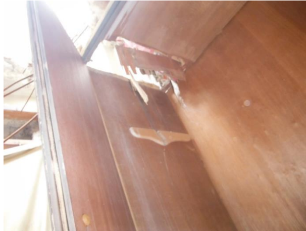
РИСУНОК 50. ФОТОГРАФИЯ ПОВРЕЖДЕННОЙ ДУШЕВОЙ КАБИНЫ. ПОВРЕЖДЕНИЕ, ВЕРОЯТНО, ВЫЗВАНО ЧАСТЯМИ СБОРКИ БАЛЛОНА (ИСТОЧНИК: МУФ)
