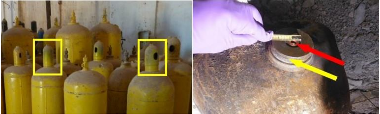
РИСУНОК 9. СЛЕВА: ЖЕЛТЫЕ ПРОМЫШЛЕННЫЕ БАЛЛОНЫ С УСТАНОВЛЕННЫМИ ЗАЩИТНЫМИ КОЛПАЧКАМИ КЛАПАНОВ (ОТМЕЧЕНЫ ЖЕЛТЫМИ КВАДРАТАМИ). СПРАВА: БАЛЛОН, НАЙДЕННЫЙ В МЕСТЕ 2, С НАРУЖНОЙ РЕЗЬБОЙ БЕЗ ВИДИМЫХ МЕХАНИЧЕСКИХ ПОВРЕЖДЕНИЙ. (ИСТОЧНИК: ОЗХО И МУФ)
