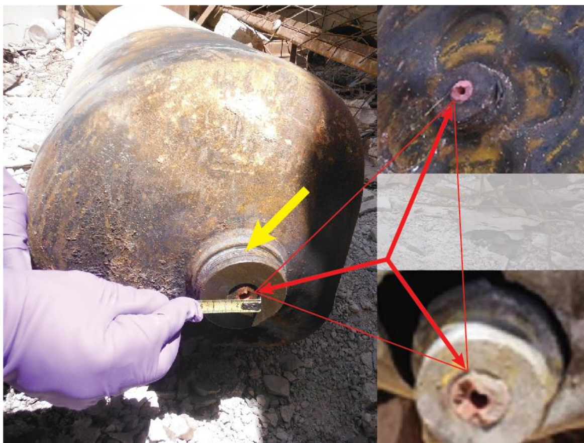
РИСУНОК 10. УВЕЛИЧЕННОЕ ИЗОБРАЖЕНИЕ (ИСТОЧНИК: МУФ): ПРОМЫШЛЕННЫЙ БАЛЛОН, ОБНАРУЖЕННЫЙ В МЕСТЕ 2, С ВИДИМЫМ КЛАПАНЫМ ОТВЕРСТИЕМ. СЛОМАННЫЙ КОРПУС КЛАПАНА (ЧАСТЬ КОТОРОГО ВСЕ ЕЩЕ ВКРУЧЕНА В ОТВЕРСТИЕ БАЛЛОНА) ОТМЕЧЕН КРАСНОЙ СТРЕЛКОЙ, А РЕЗЬБА, ИСПОЛЬЗУЕМАЯ ДЛЯ КРЕПЛЕНИЯ ЗАЩИТНОГО КОЛПАЧКА КЛАПАНА, ОТМЕЧЕНА ЖЕЛТОЙ СТРЕЛКОЙ. АНАЛОГИЧНОЕ ПОВРЕЖДЕНИЕ КЛАПАНА (ОТМЕЧЕННОЕ КРАСНОЙ СТРЕЛКОЙ) ВИДНО НА БАЛЛОНАХ, ИСПОЛЬЗОВАВШИХСЯ В РАННЕ ЗАДОКУМЕНТИРОВАННЫХ ИНЦИДЕНТАХ С ПРИМЕНЕНИЕМ ХЛОРА В КАЧЕСТВЕ ХИМИЧЕСКОГО ОРУЖИЯ, НАПРИМЕР В КАФР-ЗАЙТЕ 1 ОКТЯБРЯ 2016 ГОДА 147 (СМ. ФОТОГРАФИЮ В СИНЕМ КВАДРАТЕ) И САРАКИБЕ 4 ФЕВРАЛЯ 2018 ГОДА (СМ. ФОТОГРАФИЮ В КРАСНОМ КВАДРАТЕ) 148 .
