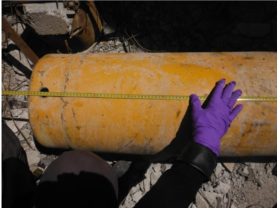
ILLUSTRATION 8 : DIAMÈTRE DE LA BASE DU CYLINDRE TROUVÉ À L'EMPLACEMENT N° 2, TEL QUE MESURÉ PAR LA MISSION LE 21 AVRIL 2018. LES DIMENSIONS DU CYLINDRE CORRESPONDENT À CELLES DU CYLINDRE UTILISÉ LORS DE L'ATTAQUE CHIMIQUE DE SARAQEB LE 4 FÉVRIER 2018 (SOURCE : LA MISSION)
