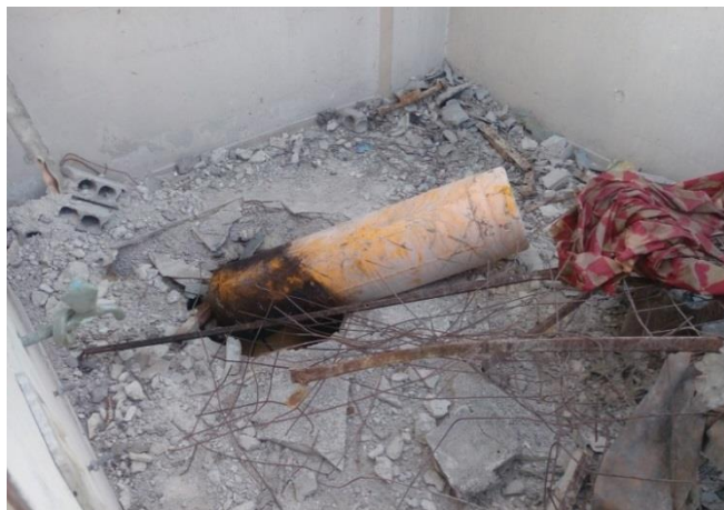
FIGURA 29: BOMBONA EN EL BALCÓN DEL LUGAR 2, QUE MUESTRA UN PATRÓN CUADRICULADO QUE SE CORRESPONDE CON LA MALLA METÁLICA
