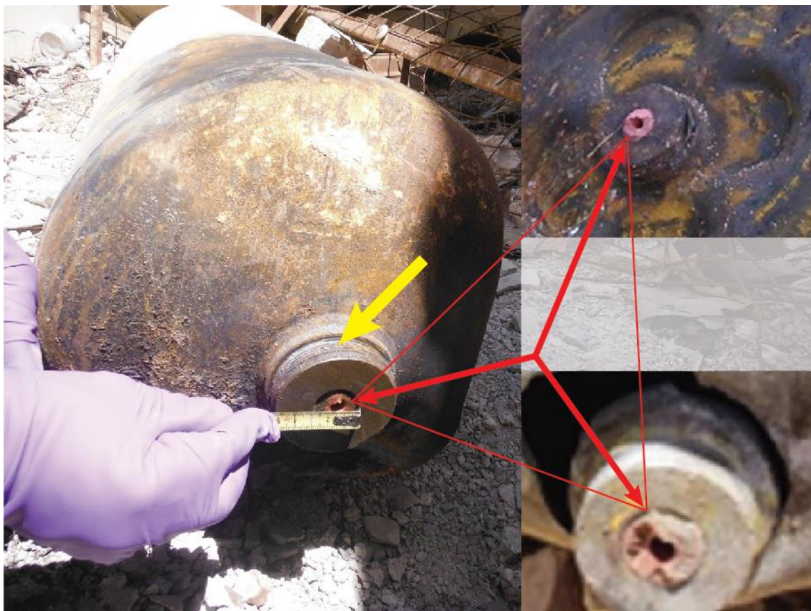
FIGURA 10: IMAGEN AMPLIADA (FUENTE: MISIÓN): BOMBONA INDUSTRIAL HALLADA EN EL LUGAR 2 CON CAVIDAD DE LA VÁLVULA VISIBLE. EL CUERPO ROTO DE LA VÁLVULA (QUE EN PARTE HA QUEDADO TODAVÍA ENROSCADO EN LA APERTURA DE LA BOMBONA) SE MARCA CON UNA FLECHA ROJA, MIENTRAS QUE LA ROSCA EMPLEADA PARA FIJAR EL CAPUCHÓN DE PROTECCIÓN DE LA VÁLVULA SE MARCA CON UNA FLECHA AMARILLA. SE DISTINGUEN DAÑOS SIMILARES DE LA VÁLVULA (MARCADOS CON UNA FLECHA ROJA) EN LAS BOMBONAS EMPLEADAS EN INCIDENTES PREVIAMENTE DOCUMENTADOS DEL EMPLEO DE CLORO COMO ARMA QUÍMICA, P. EJ., EN KAFR ZEITA, 1 DE OCTUBRE DE 2016 147 (VÉASE LA FOTOGRAFÍA EN EL CUADRADO AZUL) Y SARAQIB, 4 DE FEBRERO DE 2018 (VÉASE LA FOTOGRAFÍA EN EL CUADRADO ROJO) 148 .
