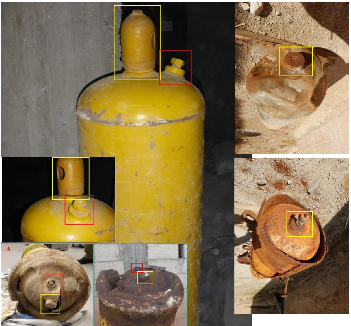
FIGURA 27: EN LA IMAGEN AMPLIADA: BOMBONA AMARILLA INDUSTRIAL HALLADA EN EL EMPLAZAMIENTO DEL ALMACÉN. LA BOMBONA NO ESTÁ SUJETA CON UNA CUNA Y TIENE MONTADO UN CAPUCHÓN DE PROTECCIÓN DE LA VÁLVULA (MARCADO CON UN CUADRADO AMARILLO). LA PARTE SUPERIOR DE LA MISMA BOMBONA APARECE EN LA IMAGEN MÁS REDUCIDA (MARCADA EN BLANCO). EN LAS IMÁGENES INFERIORES, BOMBONAS CON LAS MISMAS CARACTERÍSTICAS QUE LAS EMPLEADAS EN LOS INCIDENTES DE KAFR ZEITA (1 DE OCTUBRE DE 2016) (MARCADA EN VERDE) Y AL LATAMINA (25 DE MARZO DE 2017) (MARCADA EN AZUL).
