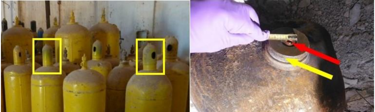
FIGURA 9: A LA IZQUIERDA: BOMBONAS INDUSTRIALES AMARILLAS CON CAPUCHONES DE PROTECCIÓN DE LA VÁLVULA COLOCADOS, MARCADOS CON UN CUADRADO AMARILLO. A LA DERECHA: BOMBONA HALLADA EN EL LUGAR 2 CON ROSCA EXTERNA SIN DAÑOS MECÁNICOS VISIBLES (FUENTE: OPAQ Y MISIÓN)
