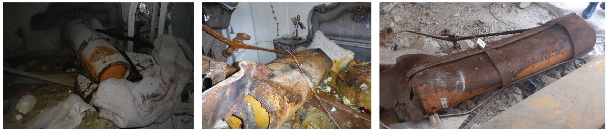
FIGURA 23: SERIE DE IMÁGENES DE LA BOMBONA HALLADA EN EL LUGAR 4 QUE MUESTRAN SU CORROSIÓN PROGRESIVA, TOMADAS EL 9 DE ABRIL DE 2018 (FUENTE GII-OPAQ), 25 DE ABRIL DE 2018 (FUENTE: MISIÓN) Y 16 DE NOVIEMBRE DE 2020 (FUENTE: OPAQ), RESPECTIVAMENTE.
