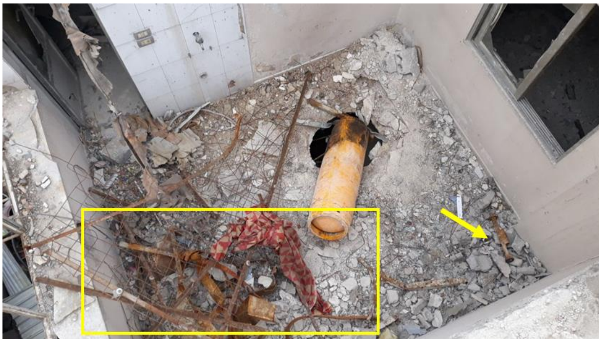
FIGURA 14: CUNA DESPRENDIDA VISIBLE CERCA DE LA BOMBONA EN EL LUGAR 2 (FUENTE: MISIÓN)
