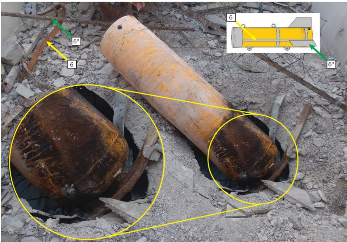
FIGURA 13: LA CONFORMACIÓN DE LAS GOTAS DE CONDENSACIÓN SECAS SE MARCA CON UN CUADRADO AMARILLO (FUENTE: MISIÓN)
