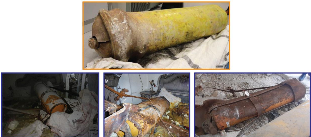
FIGURA 24: PAUTA DE CORROSIÓN DE BOMBONAS SIMILARES UTILIZADAS EN OTROS INCIDENTES DEL EMPLEO DE ARMAS QUÍMICAS (FUENTE: OPAQ, MISIÓN)
